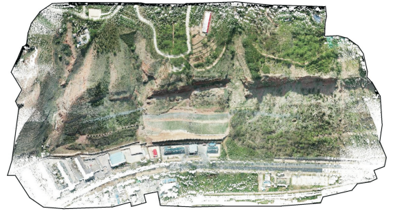
图 3 基于点云数据的滑坡体实景三维模型
